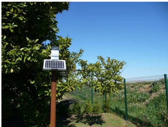
Exemple d'un capteur sur un réseau H 2 S sur station d'épuration
