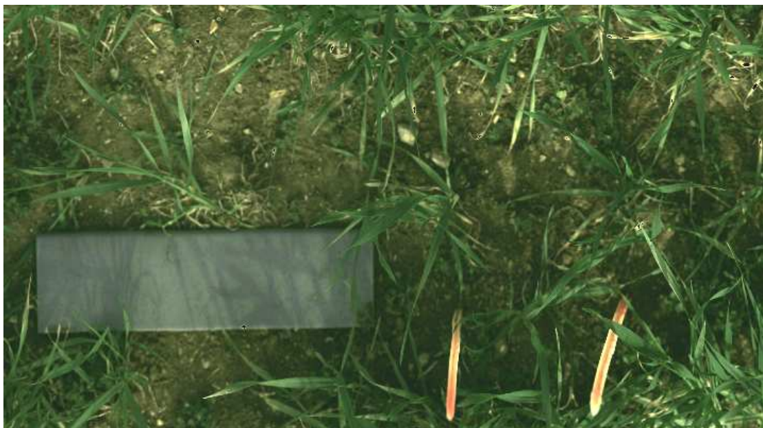
Fig. 2: Image de relevé des spectres (on distingue à gauche la céramique de référence d'éclairement)
